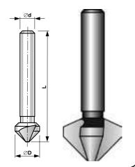
Kuželové záhlubníky **DIN 335 C Countersinks DIN 335 C** Kegelsenker DIN 335 C Конические шенкера **DIN 335 C**
